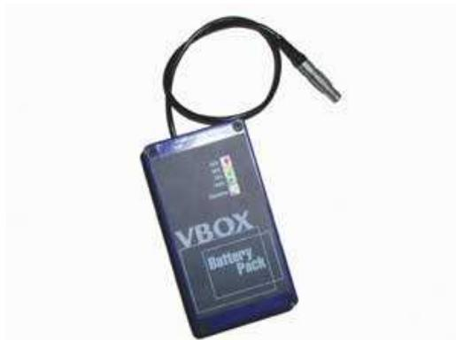
Le pack batterie est une unité nickel métal hydride de 6 v, 3,8 amp. avec un circuit intégré chargeur et surveillance. La batterie se branche dans la prise à deux pôles à l'avant de la VBOX et elle permet une autonomie de 5 heures (4 heures avec l'écran).
