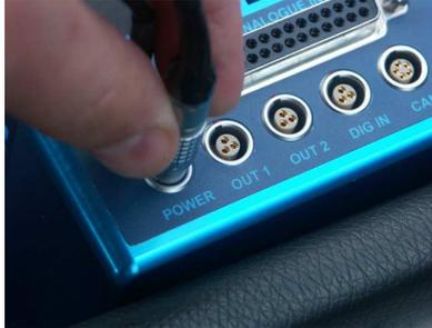
8. Bei Verwendung eines Netzkabels mit 12 V am Fahrzeug anschließen
