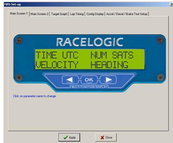
De là, il est possible de régler toutes les fonctions et paramètres d'affichage de l'écran Multifonctions. A droite, l'écran de configuration pour les fonctions de Chronométrage de tours de l'écran Multifonctions.
