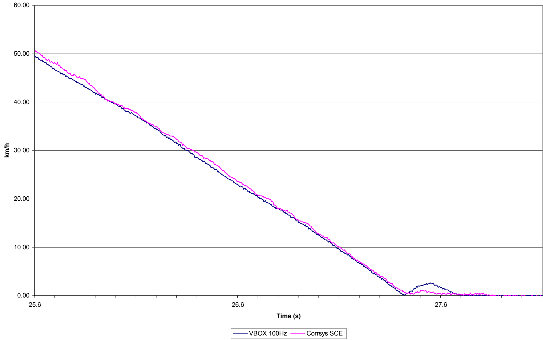
VBOX 100Hz vs Corrsys SCE sensor
